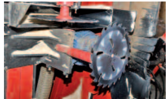
Links: Ein Blick auf die komplette Anlage. Der Bediener sitzt in einer staubfreien und klimatisierten Kabine und hat von da oben die gesamte Anlage im Blick. Oben und unten: Die rechtwinklig zueinander stehenden Blätter schneiden sehr schnell und dadurch sehr sauber.
