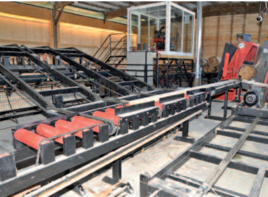
Links: Ein Blick auf die komplette Anlage. Der Bediener sitzt in einer staubfreien und klimatisierten Kabine und hat von da oben die gesamte Anlage im Blick. Oben und unten: Die rechtwinklig zueinander stehenden Blätter schneiden sehr schnell und dadurch sehr sauber.
