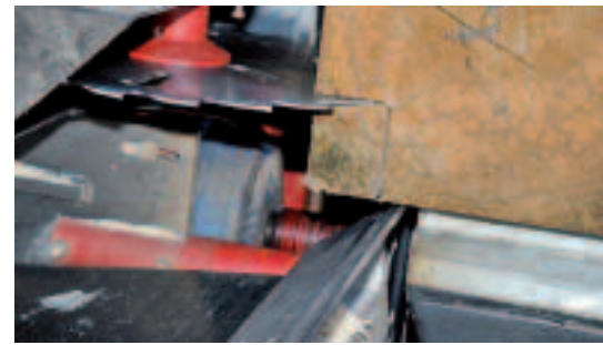
Links: Ein Blick auf die komplette Anlage. Der Bediener sitzt in einer staubfreien und klimatisierten Kabine und hat von da oben die gesamte Anlage im Blick. Oben und unten: Die rechtwinklig zueinander stehenden Blätter schneiden sehr schnell und dadurch sehr sauber.
